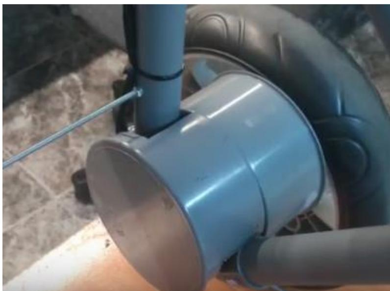
Las ruedas delanteras son giratorias y utilizaremos varilla roscada M4 como tensores entre las patas.
